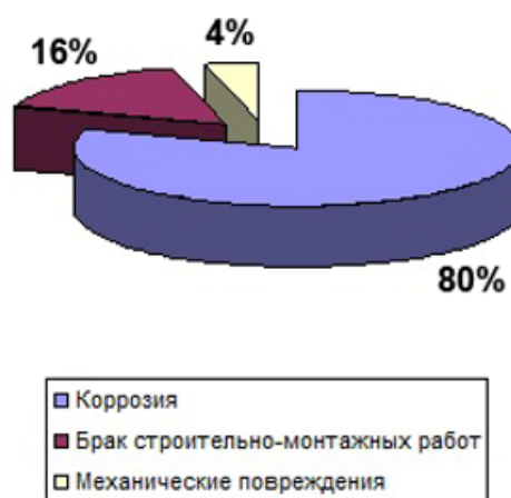
Рисунок 1. Основные причины выхода из строя внутрипромысловых трубопроводов
