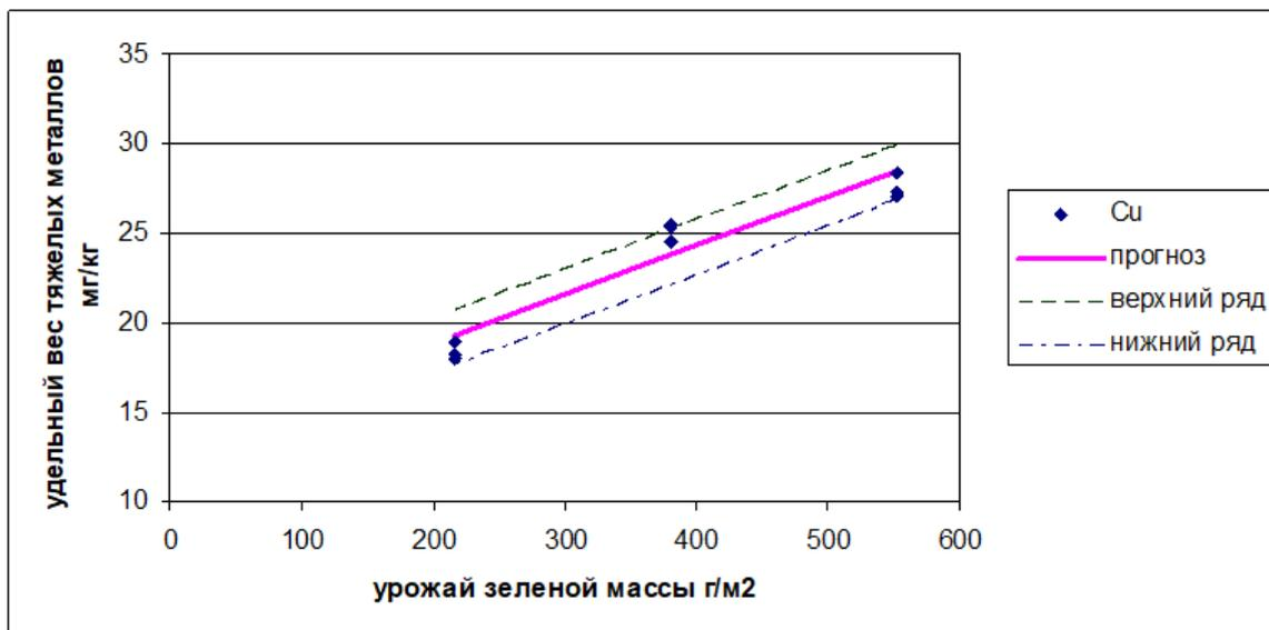
Рис. 1 Зависимость эффективности извлечения меди биосорбентом от зеленой массы
